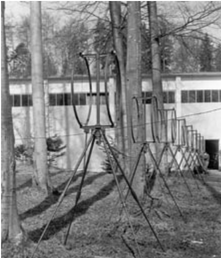
Bild 2: HF-Richtempfangsantenne der Firma EMI, zusammengesetzt aus aktiven Doppelrahmen.
