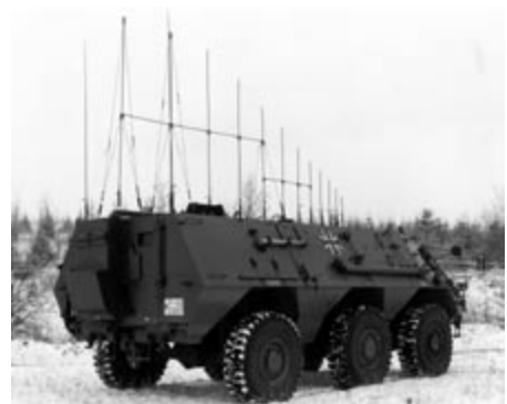
Bild 9: Der „Störpanzer Fuchs“ mit l/p-Antenne 20-80 MHz (AEG-Telefunken/SEL).
