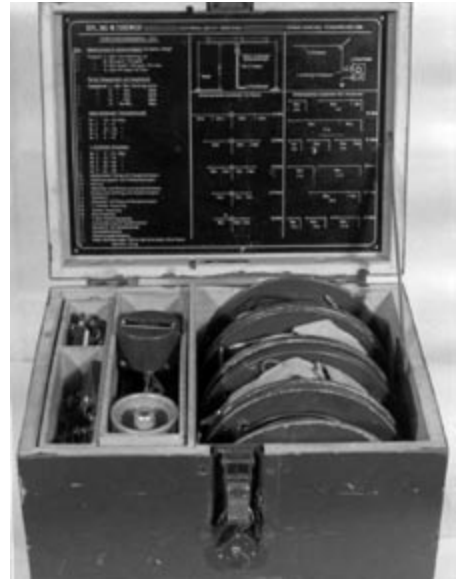
Bild 3: Antennenbaukasten der Firma Turowski mit HF-Dipol- und Langdrahtantennen verschiedener Länge sowie Anpassübertragern.
