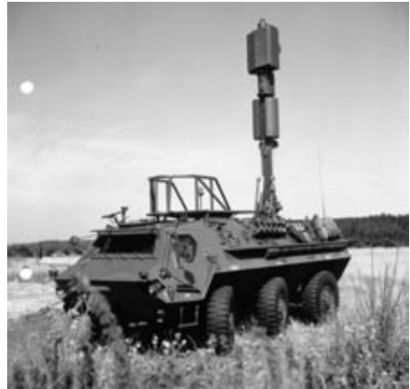
Bild 16: EloAufklärungspanzer „HELAS“ mit hydraulisch aufgerichteter Aufklärungsantenne. Die beiden tonnenförmigen Behälter am Mast unterhalb der Antenne enthalten Schlitzantennen für die UHF-Datenverbindung zur Auswertung
