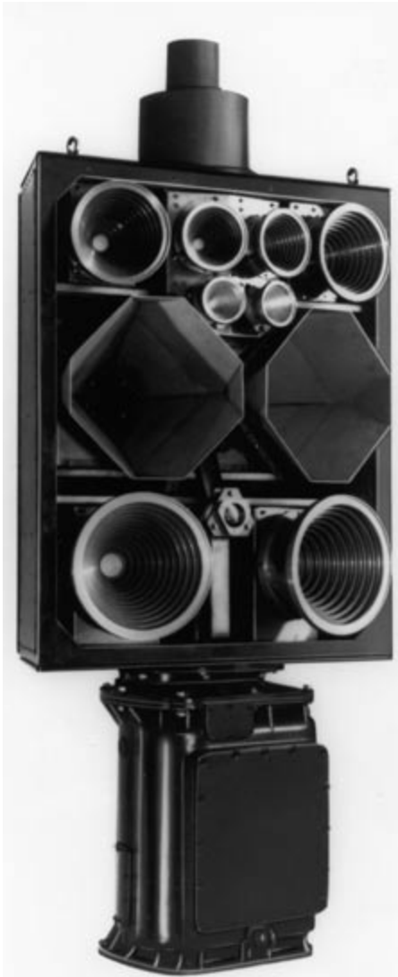
Bild 15: Antennensystem der EloAufkl-Anlage „HELAS“ der Firma Siemens mit den fünf Monopuls-Hornpaaren für 1,5-18 GHz, unten das Drehsystem und oben (verkleidet) zwei Breitband-Rundempfangsantennen.
