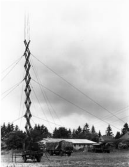
Bild 18: Scherengittermast des 20-kW-HF-Störsenders nach dem Aufrichten.
