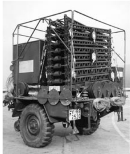
Bild 19: Anhänger des 20-kW-Störsenders im Transportzustand mit Antennenanpassgerät und zusammengefaltetem Gittermast
