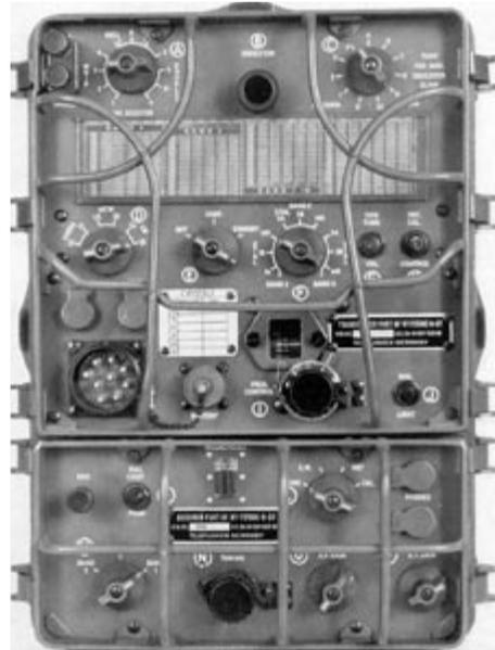
**Bild 4:** Frontplatte des Sendeempfängers: oben der Sendeteil, unten der Empfängerteil. Ganz oben Antennenumschalter, Glimmlampe als Abstimmhilfe und Feinabstimmung der Antenne; in der Mitte Skalenfenster und Drehknopf zur Einstellung der Sendefrequenz; unten die Frequenzabstimmung des Empfängers.
