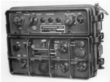
Bild 7: Empfänger R-77 (oben die Transistor-Stromversorgung PP-77).
