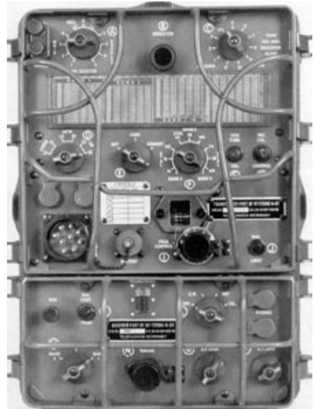
Bild 4: Frontplatte des Sendeempfängers: oben der Sendeteil, unten der Empfängerteil. Ganz oben Antennenumschalter, Glühlampe als Abstimmhilfe und Feinabstimmung der Antenne; in der Mitte Skalenfenster und Drehknopf zur Einstellung der Sendefrequenz; unten die Frequenzabstimmung des Empfängers.
