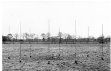
Bild 18: Modernes HF-Adcock-Antennensystem mit aktiven Antennenelementen von etwa einem Meter Höhe für mobilen Einsatz
