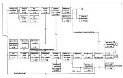
Bild 3: Blockschaltbild des Sendeempfängers RT-66.
