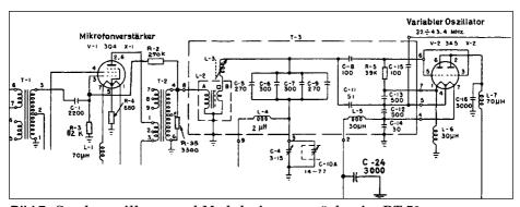
Bild 7: Senderoszillator und Modulationsverstärker im RT-70.
