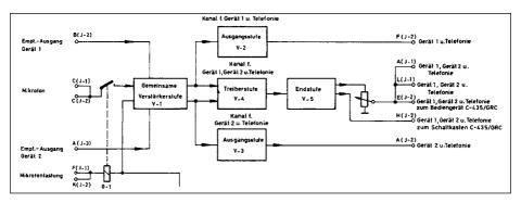
Bild 8: Blockschaltbild AM-65 (Telefonie = Bordsprechanlage).
