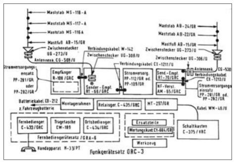
Bild 2: Einzelgeräte des Funkgerätesatzes GRC-3
