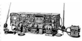
Bild 1: Links der Zusatzempfänger, mittig der Sendeempfänger eins mit seinem Stromversorgungsgerät, rechts oben der Sendeempfänger zwei, darunter der Bordsprechverstärker, in der Mounting das Relaisgerät C-345, ganz rechts der Schaltkasten C-375.
