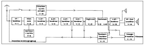
Bild 5: Blockschaltbild des Zusatzempfängers R-108.
