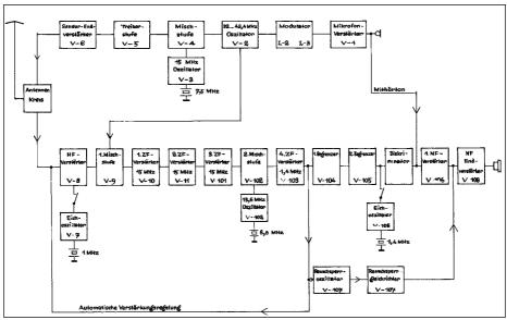
Bild 6: Blockschaltbild des Sendeempfängers RT-70.
