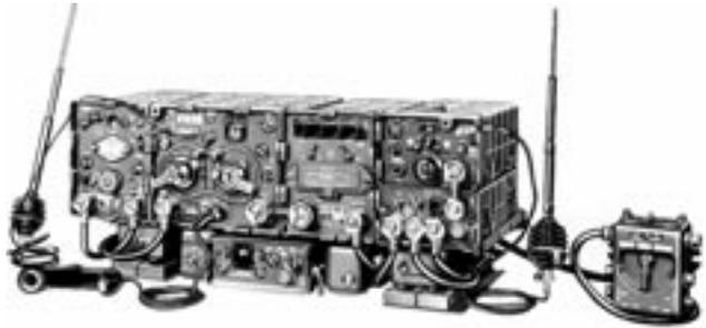
**Bild 1:** Links der Zusatzempfänger, mittig der Sendeempfänger eins mit seinem Stromversorgungsgerät, rechts oben der Sendeempfänger zwei, darunter der Bordsprechverstärker, in der Mounting das Relaisgerät C-345, ganz rechts der Schaltkasten C-375.
