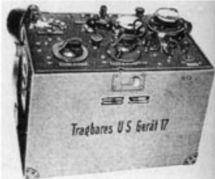
**Bild 17:** Ältester Röhrensender ARS 60 der „Schützengrabenstation“ (3 W; 545 bis 1200 kHz), aus [20].
