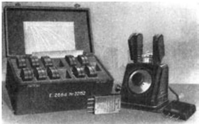
**Bild 16: Zubehörkasten des Empfängers E 266 mit Spulensätzen für 7,5-2000 kHz, aus [13].**
