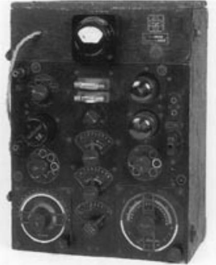
**Bild 18:** Empfänger E 225 des „F-Geräts“, aus [20].
