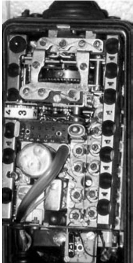
zeln vorgenommen werden, und zwar durch entsprechendes Drehen an der jeweiligen Nockenstellschraube. Hierbei wird das gleiche Kanalabgleichgerät ID-292 wie beim PRC-6 verwendet.
