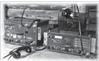
Bild 4: Sender T-14 (links) und Empfänger R-19 (rechts), oben Bundeswehr-Feldfernsprecher OB/ZB.
