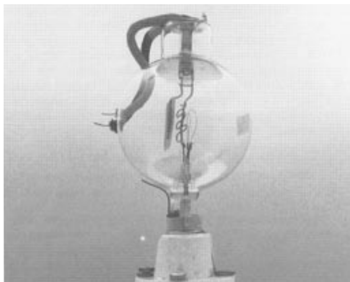
Bild 538 [Sammlung Radtke, Gütersloh] Replica des «single wing audion» von de Forest
