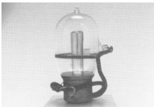
Bild 537 [Sammlung Radtke, Gütersloh] Diode von Fleming, Baujahr 1904
