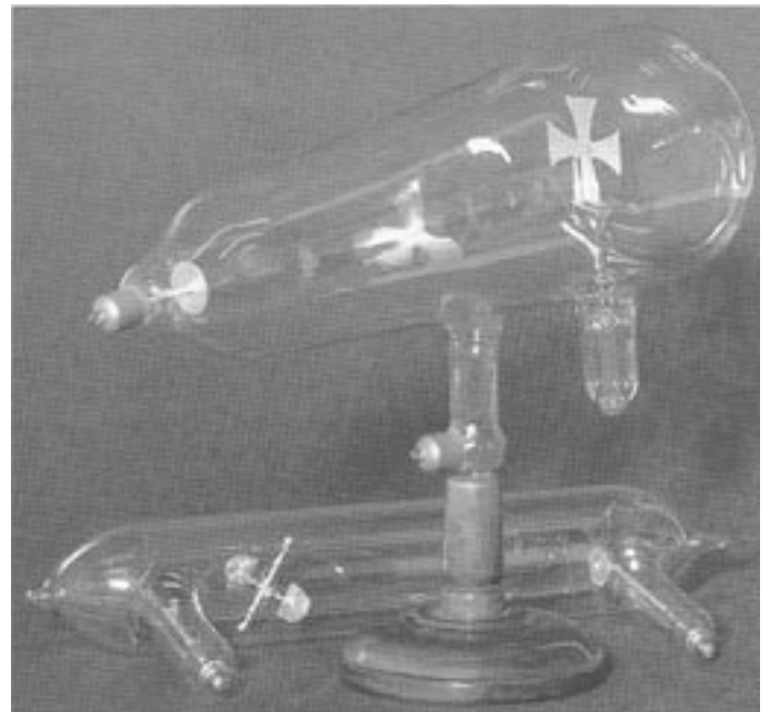
Bild 534 [Sammlung Erb, Luzern] Crookesche Röhren: Mit klappbarem Kreuz (stehende Röhre). Die liegende Röhre beinhaltet ein Flügelrad, das sich auf der Achse und Glasschienen im Kolben von einer zur anderen Seite bewegen kann
