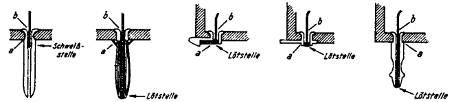
Bild 577 [220-65] Schweiss- und Lötstellen des Herstellers
