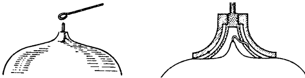
Bild 575 [220-60] Abgefilete Glasspitze, Schnitt durch zweiteilige Anodenkappe
