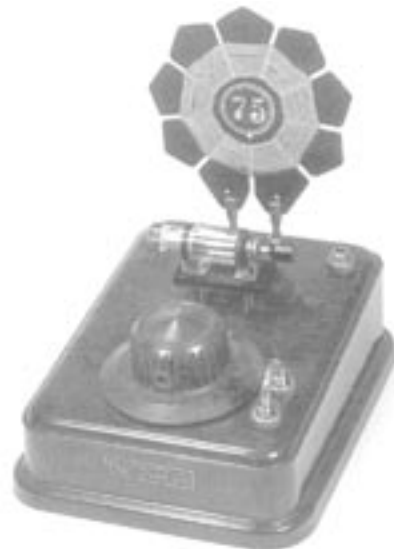
Bild «Z1» T94 [Z137, Sammlung Herzog, Springe] Detektor mit steckbarer Spinnweb- bzw. Spiralspule. Abstimmung durch Drehkondensator, Aufsteckdetektor in Glasröhrchen. Marke NORA, Mod. DAB50, 1930-33, Press-Stoff, 125x070x163 BHT, 300 g Gewicht.
