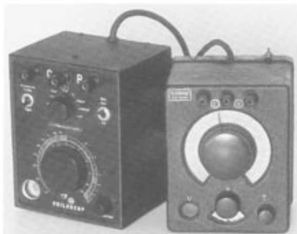
Bild «Z1» I33 [Sammlung Erb/Heigl] 2 Philips-RC-Prüfgeräte aus den 40er/50er Jahren. Mod. MB2023 «Philoscop» mit AF7, AB2 und EM4. Daneben Mod. GM4140A
