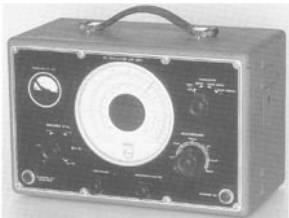
Bild «Z1» I5 [Sammlung Erb/Heigl] Prüfsender Philips GM2883/02, 1952, 330 x 230 x 200 mm BHT, 90 kHz - 30 MHz. Röhren 3x EF41, 2x EF50N, AZ41, Glimm-Sta- bi 150A1
