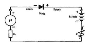
Stromfluss in DURCHLASSRICHTUNG, in Schalterstellung ID auf Messbereich 0 - 250 mA oder auf 0 - 100 mA.
