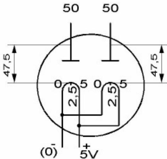
Die Röhre verhält sich hinsichtlich der Heizspannungsverhältnisse wie zwei Einzelröhren. Bei Gleichspannungsheizung verschieben sich die Spannungen für beide Systeme um  $\frac{1}{2}$  Heizspannung, hier also 2,5V. Will man mit Gleichspannungsheizung dieselben Verhältnisse wie bei Wechselstromheizung simulieren, muß man also die Anodenspannung für beide Systeme einheitlich um 2,5V erhöhen.
