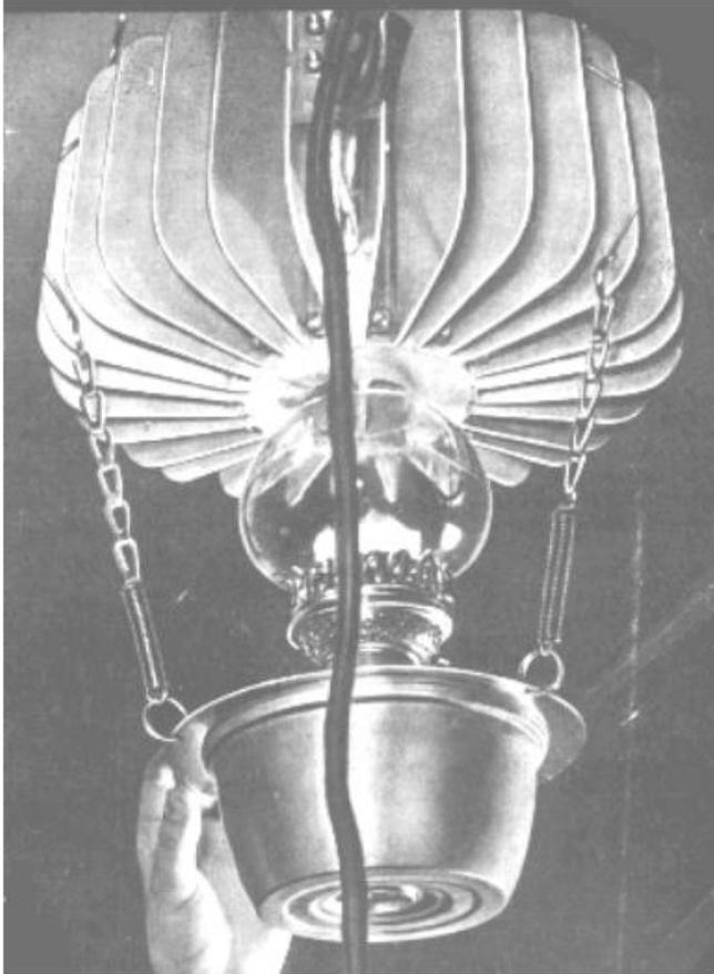
Diese Petroleumlampe verbraucht 60 bis 70 g Brennstoff pro Stunde und erzeugt außer Licht auch noch den Strom für die Batterieempfänger „Rodina“ oder „Iskra“.
