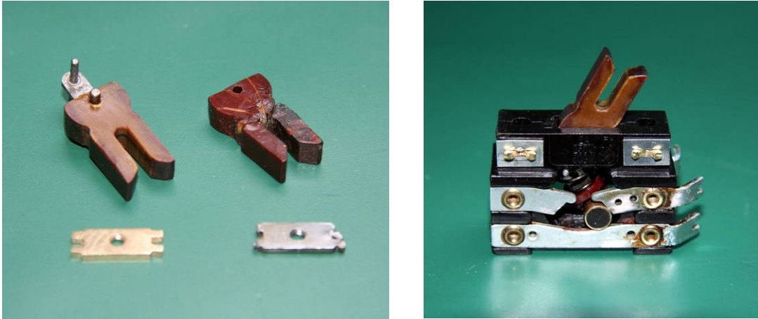
Bild 7: Netzschalter, Einzelteile und wiederhergestellter Schalter
