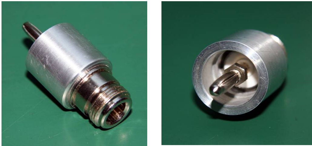
Bild 40: Adapter von Bananenstecker (Ln21021) auf N-Connector
