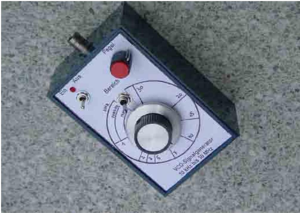
Ein VCO (Voltage Controlled Oscillator) ist ein Frequenzgenerator, bei dem durch Veränderung einer Gleichspannung an einem Steuerterminal die Ausgangsfrequenz eingestellt werden kann.
