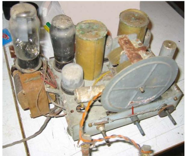
Die Röhrenbestückung war nicht mehr original. Anstatt der ECL11 existierte eine EL11 und in der Fassung der AZ11 war eine EF11. Die Gleichrichterröhre AZ11 war mit einem Metallhalter über dem Netztrafo montiert.
