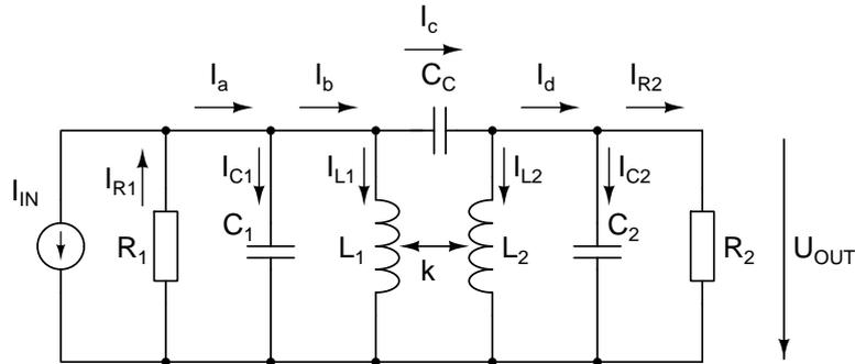
Abbildung 1: Bandfilter mit Definition der Ströme
