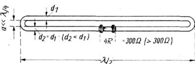
Bild 11. Doppeldipol (Dublette) mit nur einseitiger Mittelunterbrechung
