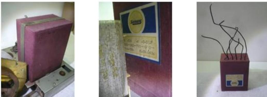
Anschließend wurde der Block geöffnet. Dazu wurde das Papier rund um die Unterseite angefeuchtet und das die Unterseite bedeckende Papier vorsichtig abgelöst. Zum Vorschein kam ein Deckel aus Hartpappe, der mit Messer und Stemmeisen vorsichtig abgehoben wurde.
