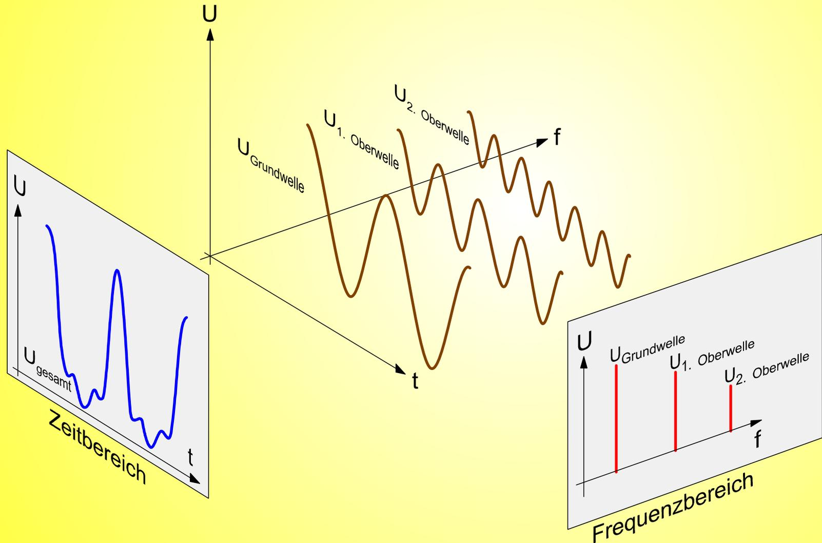
Jede periodische Funktion (Zeitbereich) kann durch eine Reihe von Sinus- und Cosinusfunktionen (Frequenzbereich) dargestellt werden. (Fourier-Transformation)
