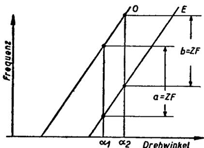
Abb. 869. Abstimmkurven des Eingangs- und des Oszillatorkreises
