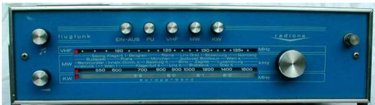
Auch beim **Radione Gipsy UKW** Flugfunkempfänger wurde, ebenso wie beim bereits früher im Museumsboten besprochenen **Minerva UKW- Transistor**, der Oszillator- und Eingangskreis modifiziert, der Ratiodetektor durch einen einfachen AM- Demodulator ersetzt und die Skala geändert.
