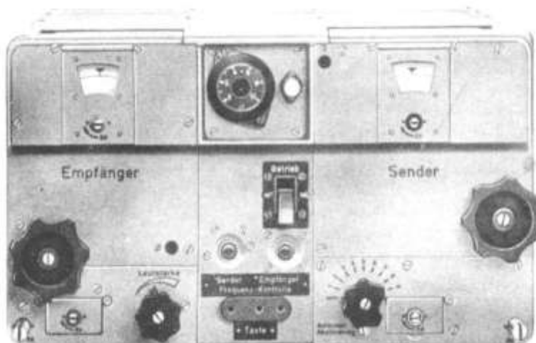
10-W-UKW-Sprechgerät Lo 10 UK 39 (37,8-45,5 MHz) in der Ur-Version von 1938.
