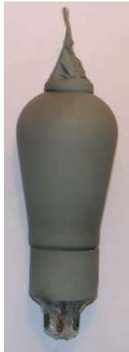
Bild 4: Lackierung mit Zinkspray
