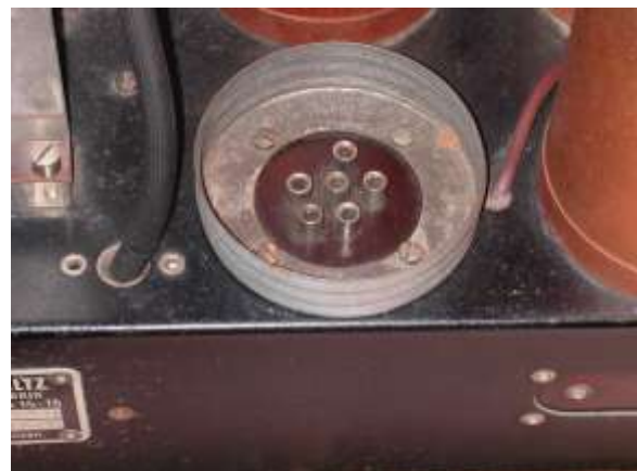
Bild 4: ZF-Röhrenfassung im Radione FSW
