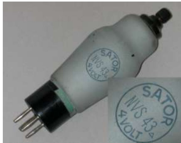
Bild 2: NVS43 mit fünf Stiften
