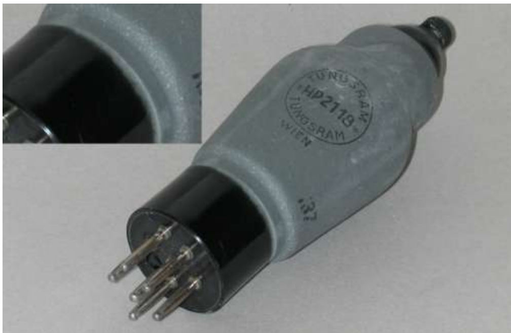
Bild 5: HP2118 von Tungstram mit sechs Sockelstiften
