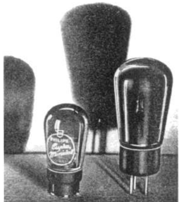
Bild 9: Cupra Gleichrichterröhre (links)
