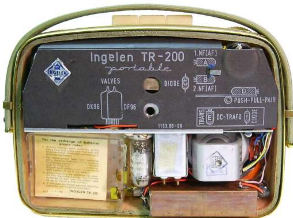
Ingelen TR 200 mit abgenommener Rückwand
