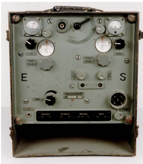
Tornisterfunkgerät d2 mit Zubehörtornister
