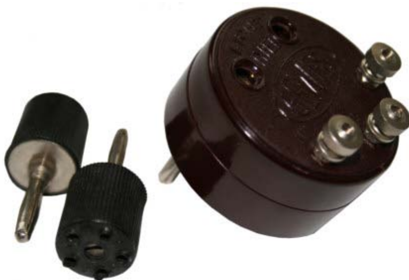
GEWES Lichtnetzantenne mit Telefonverteiler
