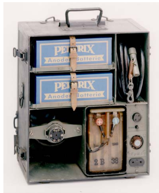
Tornisterfunkgerät d2 mit Zubehörtornister
