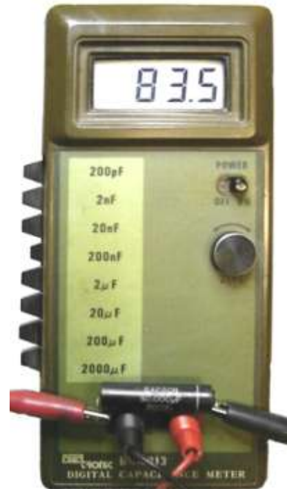
Modernes, direkt anzeigendes digitales Kapazitätsmessgerät. Der Prüfling (50 nF) zeigt einen Wert von 83,5 nF, ist also defekt.
