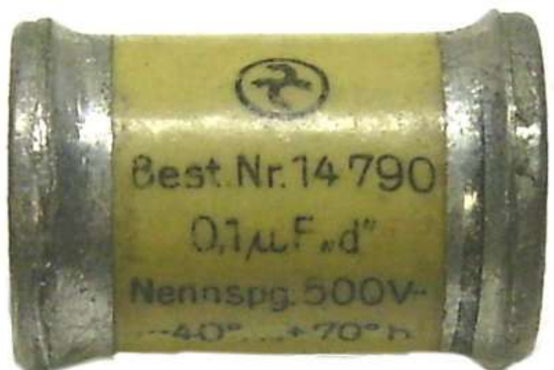
Sonderform des Rollwickelkondensators in tropenfester Ausführung
