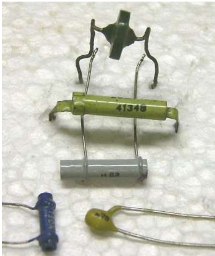
Beispiele für die verschiedenen Bauformen von keramischen Kondensatoren
