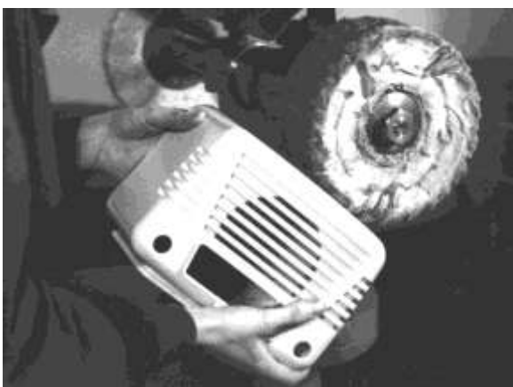
Abschließendes Polieren der Oberfläche
