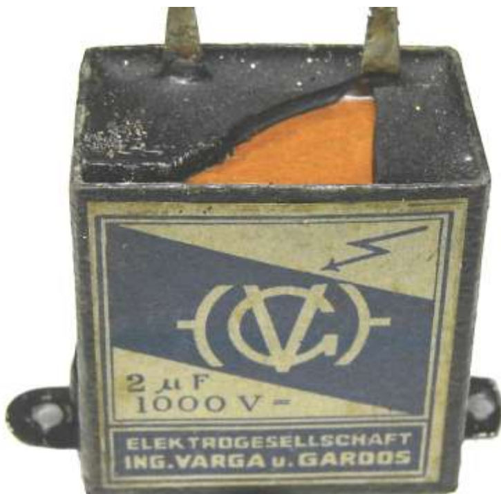
Beispiel für die defekte Vergussmasse an einem Blockkondensator
