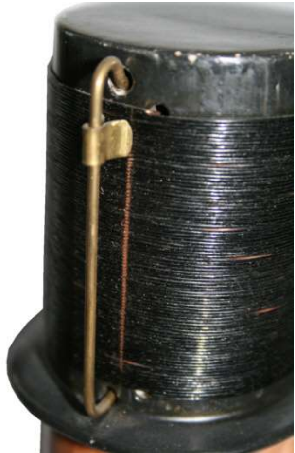
„Uncle Tom“, Detail der Spulenabstimmung
