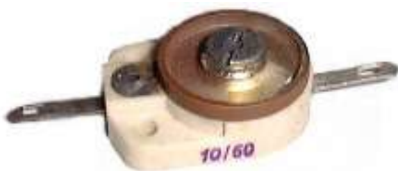
Ansicht eines keramischen Trimmers (Abgleichkondensator)
