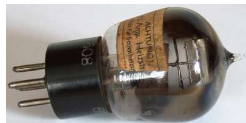
Bild 4, Hinweis auf abweichenden Heizstrom bei einer weiteren RES164 [2]
