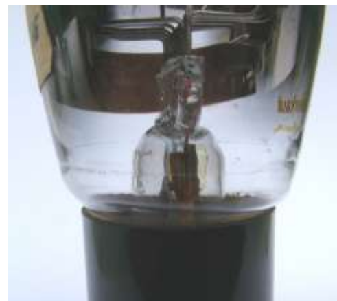
Bild 2, Trennstelle des Röhrenkolbens
