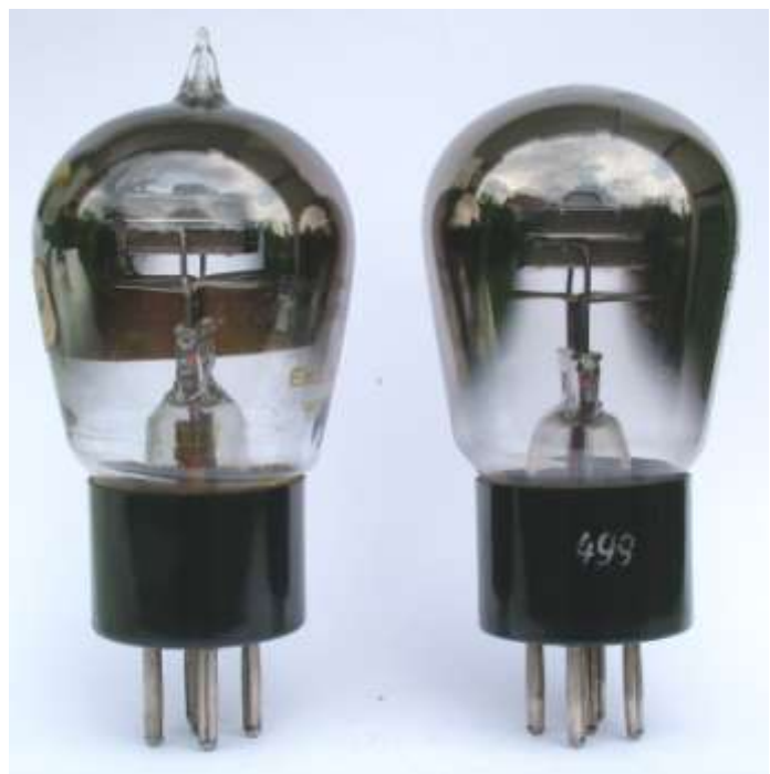
Bild 6, Reparaturröhre (links) und Originalröhre (rechts)
