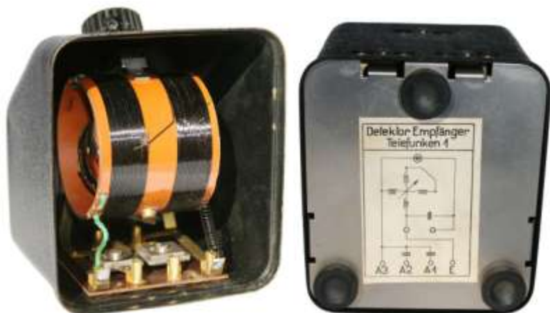
Telefunken T1, Innenansicht und Bodenplatte mit Schaltung
