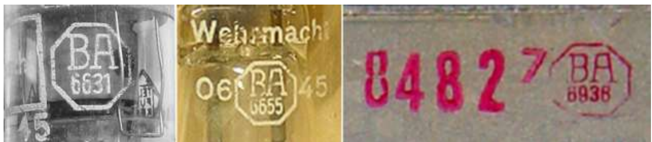
Betriebsabnahme-Stempel auf RV12P2000, LS180 und einer Baugruppe Torn.Fu.g
