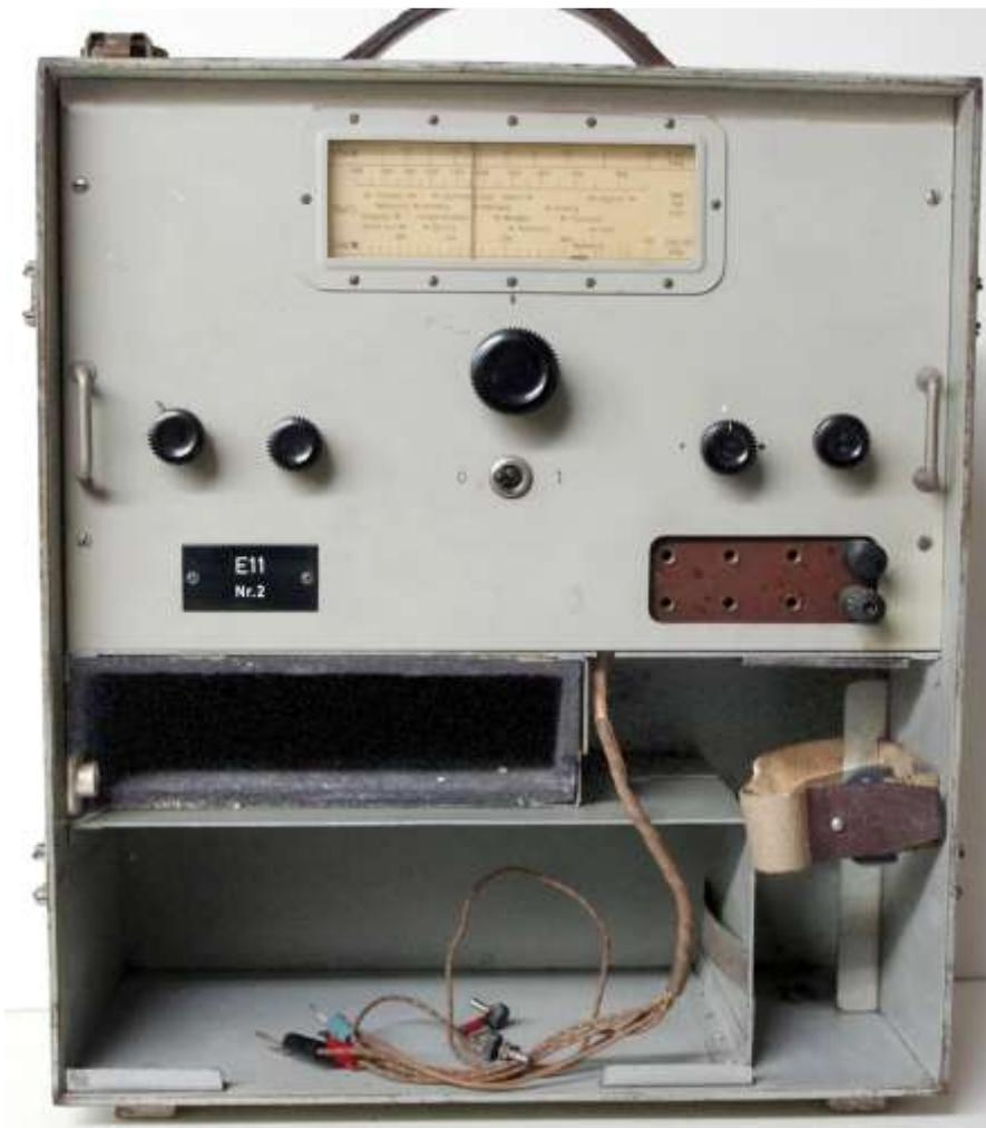
bestückt mit den K-Röhren KF3, KK2, 2 x KF3, KB2, KC3 und KL1, robust aufgebaut in einem Tornistergehäuse aus Panzerholz, das auch die Batterien und Zubehör enthält. Als Antenne dient eine auf 1,6 m ausziehbare Teleskopantenne, für die ein Schraubgewinde auf der Oberseite des Gehäuses vorgesehen ist.
