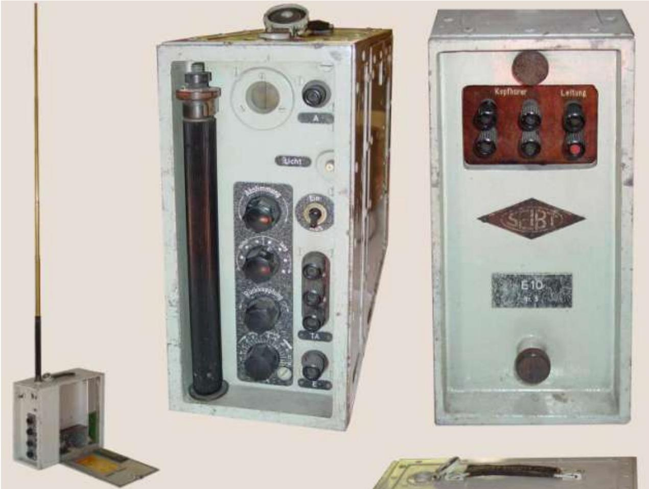
Zugang zu Batterien und Zubehör. Als Antenne dient ein 1,6 m langer Teleskopstab, der seine Transportlage an der Frontseite hat. Eine Drahtantenne und Erde können angeschlossen werden.
