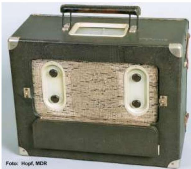
Der Körting „Tourist“ hat zwei unabhängige Rahmenantennen für Lang- und Mittelwelle, die räumlich voneinander entkoppelt sind. Die eine befindet sich in der hölzernen Lautsprecherschallwand, die andere in der hochklappbaren Rückwand.
