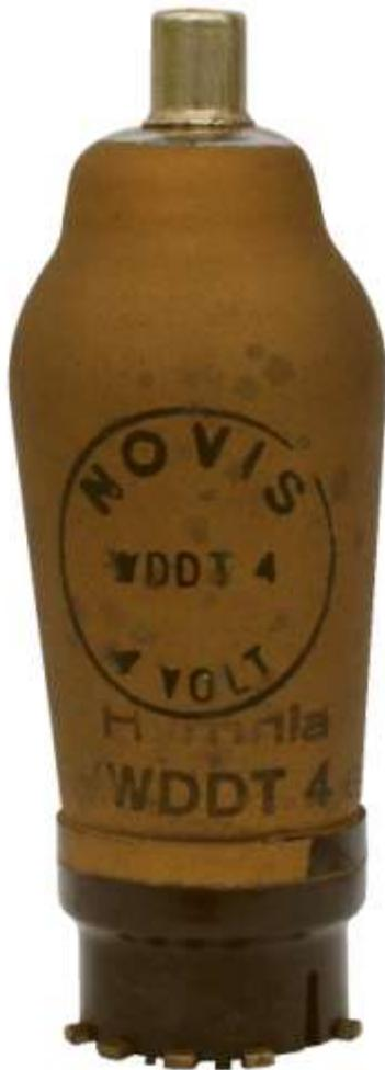
**Abbildung 5: Charakteristische Hymnia-Beschriftung von Novis-Röhren**
