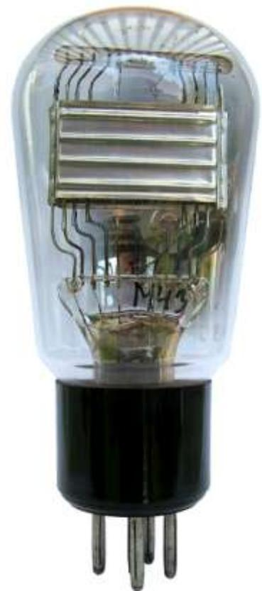
**Abbildung 3: Novis 3SP4 mit Sator-Typenbezeichnung am Quetschfuß**
