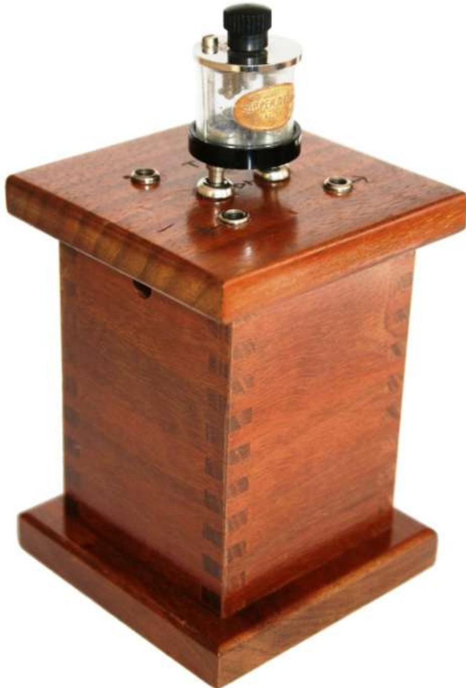
*Eigenbau-Detektorapparat mit Fixabstimmung*
