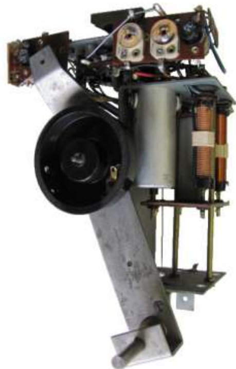
Das ausgebaute Permeabilitäts-Aggregat
