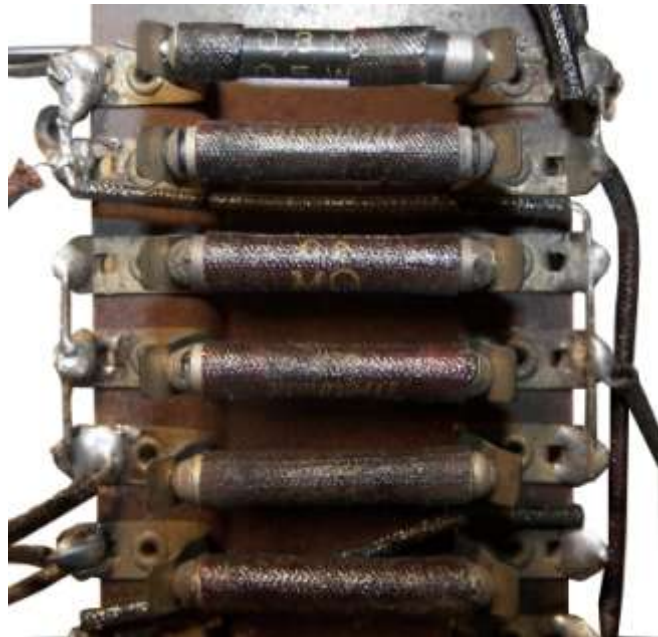
Typischer Schaltungsaufbau in Klemmtechnik (ca. 1933)
