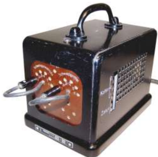
Schaltung und Gesamtansicht des SIEMENS-Kleinschweißgerätes
