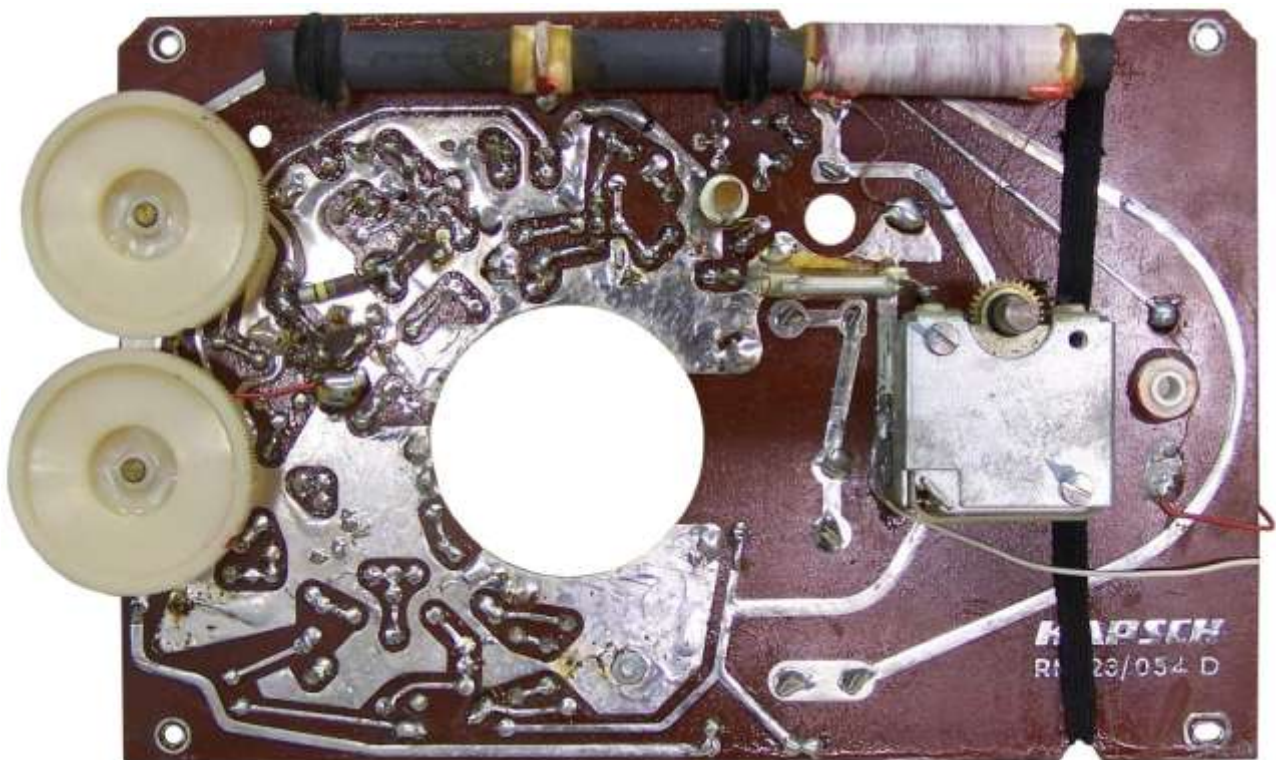
Derselbe Print, mit Blick auf die vollverzinnte Lötseite
