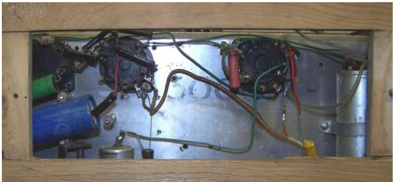
Der Blick unter das sauber an der Vorderseite abgekantete Alu-Chassis mitsamt den eingieteteten Röhrenfassungen
