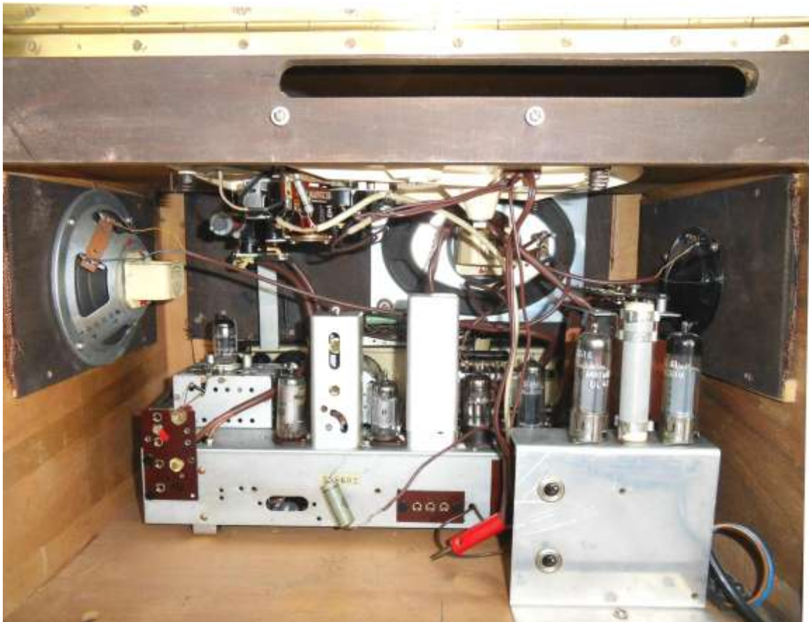
Der Blick auf das Chassis des KAPSCH Choral samt zusätzlichem Wechselrichter für das oben eingebaute Plattenspielerlaufwerk
