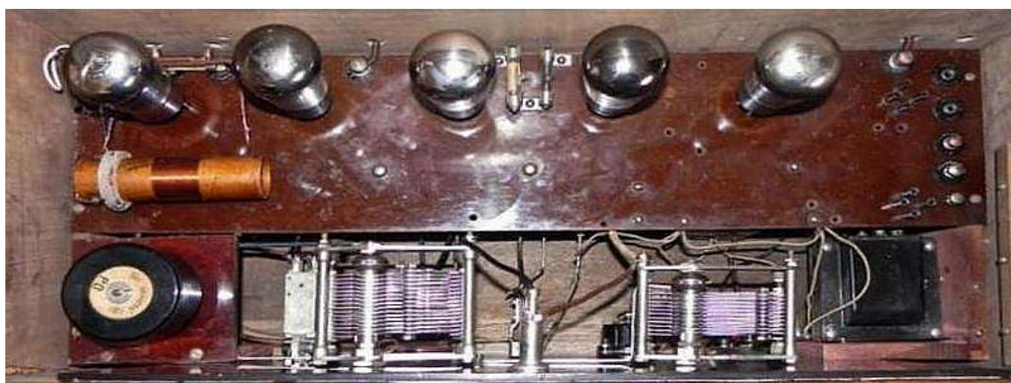
Blick auf das Chassis von oben und die fünf Röhren (beide Endröhren rechts sind entfernt), links unten die Oszillatortspule, links dahinter die Zylinderspule, die als Ersatz für die fehlende Rahmenantenne dient und von mir eingebaut wurde.
