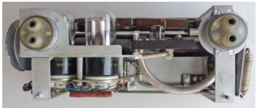
Die rechte Antennenbuchse ist zweipolig kapazitiv an den Lecherkreis angeschlossen. Die linke ist nicht angeschlossen. Die zweite Antenne ist nur strahlungsgekoppelt.
