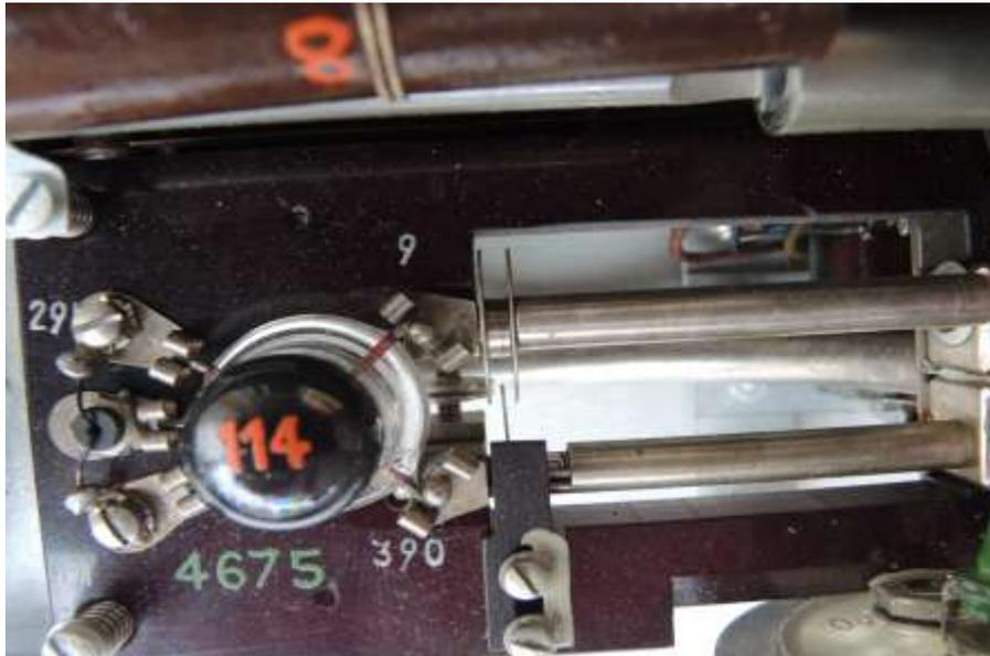
Der  $\lambda/4$ -Lecherkreis zwischen dem Gitter (Pot. 9) und der Anode (Pot. 390) der 4675 wird durch Abstandsänderung abgestimmt. Das geschieht durch ein exzentrisches Schwenken des gitterseitigen Leiters. Der Glimmer-Kondensator am rechten Ende bildet den kalten Punkt (Spannungsknoten) zum Einspeisen der Be-
