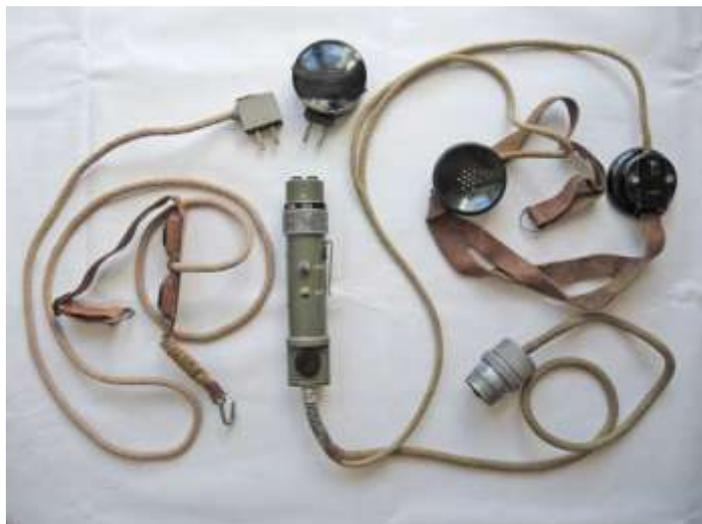
gegen das Kehlkopfmikrofon ausgetauscht werden, der Kopfhörer ist fest angeschlossen, zwei Drehschalter schalten das Gerät EIN und AUS bzw. von Telefonie auf Telegrafie um, wobei gleichzeitig der Taster freigelegt oder verborgen wird. Zwei Druckknöpfe schalten auf Senden bzw. auf Empfang. Der Steckverbinder kann entweder direkt oder über ein bis zu 40 m langes Kabel an das Gerät angeschlossen werden.
