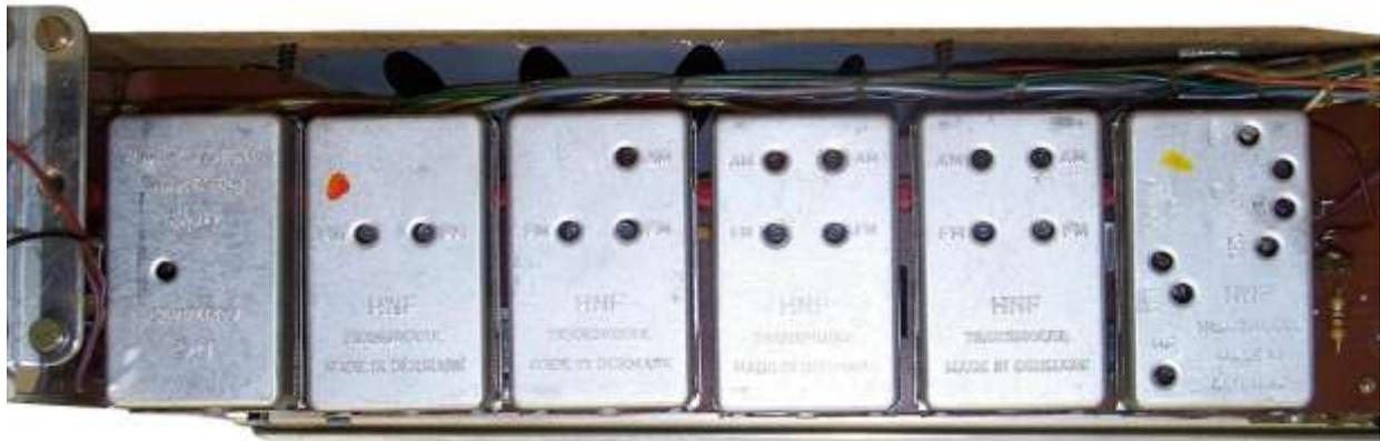
**Entfernt man die Batteriewanne an der Geräteunterseite (sechs Schrauben), wird der Blick auf die leicht zugänglichen Steckmodule frei. Um ein Modul zu ersetzen ist es nicht nötig, das gesamte Gerät zu zerlegen.**
