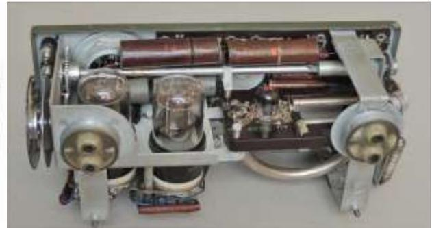
Einen Gesamtüberblick über das Chassis des Gerätes zeigen die folgenden Bilder. Der Abstimmknopf im Gehäuse ist mit den Abstimmelementen auf dem Chassis durch ein Reibradgetriebe verbunden. Die Kopplung wird erst beim Aufsetzen der Gehäusehaube hergestellt. Das funktioniert mit einem geringen Spiel.
