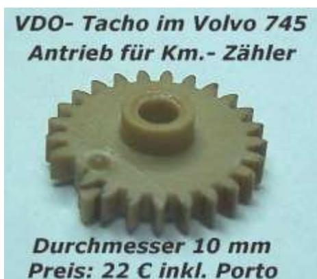
**Bild links: Zahnrad im Kilometerzähler meines 26 Jahre alten Volvo. Nach 26 Jahren kann man auch einen Defekt gerne in Kauf nehmen... Bild rechts: Diverse defekte Elkos aus einer drei Jahre alten DVBT-Box... Dies ist ein typisches Beispiel für geplante Schwachstellen!**
