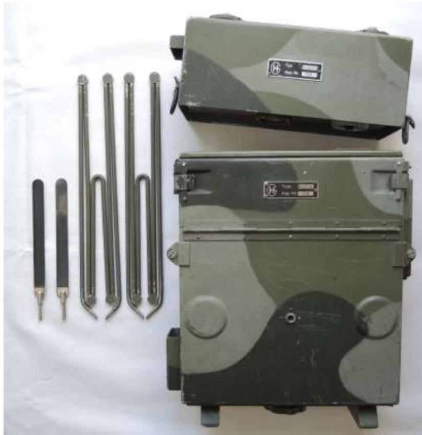
Das Apparateil ist durch zwei Kniehebel und einen Octal-Steckverbinder (wie für die Mikro-Graph-Armatur) lösbar mit dem Versorgungsteil verbunden. Bei Bedarf kann das 40 m lange Kabel zwischengeschaltet werden. Beide Teile können auf das Stativ aufgesteckt werden. Die beiden zusammengefalteten Vier-Dipol-Antennen werden zum Transport zwischen die beiden Hauben auf der linken Schmalseite federnd eingeklemmt.
