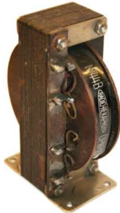
Übertrager Czeija, Nissl & Co., Radio Hekaphon, Type 44B , Übersetzungsverhältnis 1zu4, Primär 4500 Windungen., Sekundär 17.000 Windungen (Sammlung Erwin Macho)
