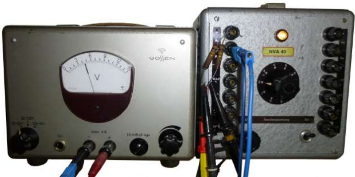
Netzteil für die Ankerwicklung und für die Regeneration
