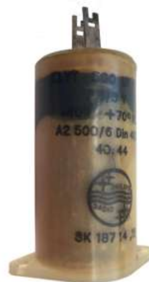
Elektrolytkondensator – PHILIPS 500uF 6V laut Stempel Baujahr 1944 in milchig transparentem Kunststoffgehäuse, unbenutzt jedoch lagerungsbedingt defekt (Sammlung Elektronikumuseum)
