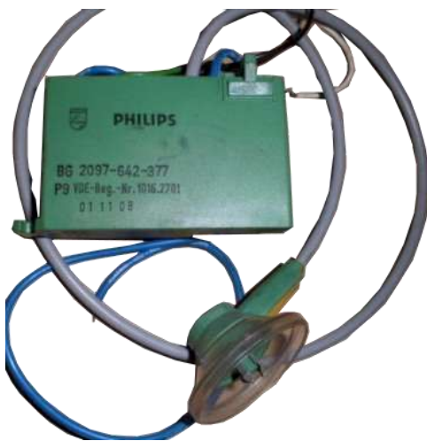
Symbolbild für die obligatorische Hochspannungskaskade für das viel verbreitete Volltransistor PHILIPS K9 Chassis der 1970er Jahre
