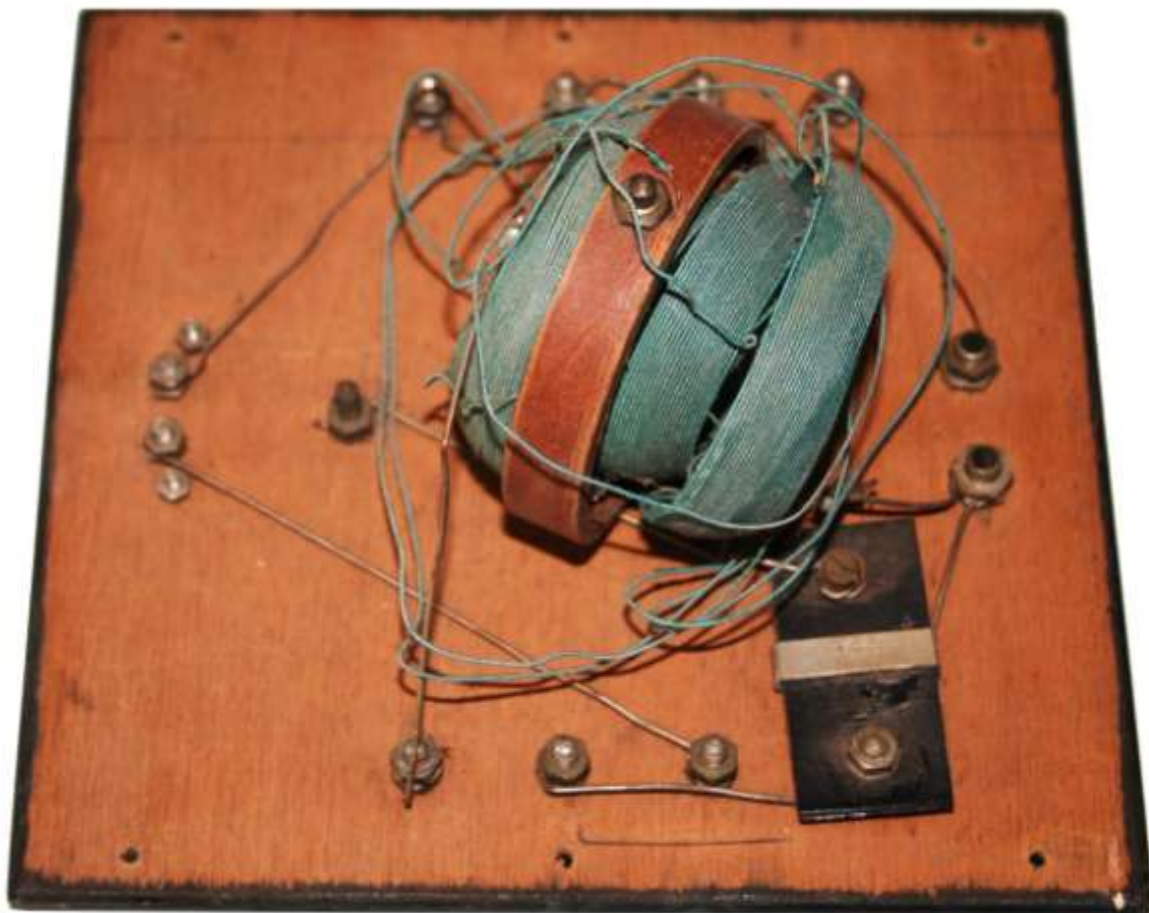
Die Unterseite der vorhandenen Bedienplatte mit Kugelvariometer
