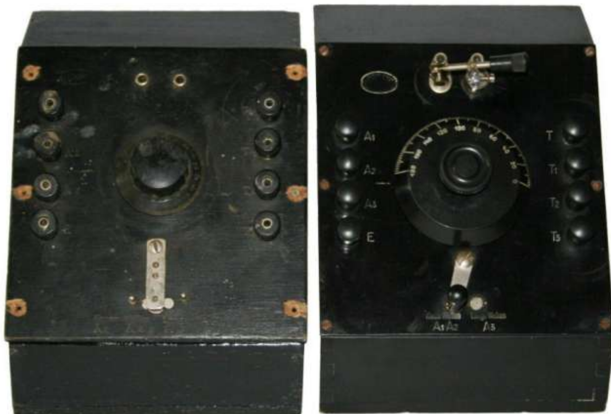
Die linke Abbildung zeigt die ULTIMA-Bedienplatte aufgesetzt auf einem Gehäuse von INGELN. Rechts zum Vergleich der INGELN-Pultdetektor
