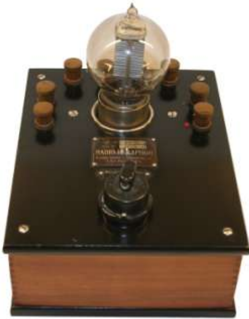
Röhrenverstärker Czeija, Nissl & Co., Radio Hekaphon, Type 89203 mit Western Electric Röhre R-216 A um 1925 (Sammlung E. Macho)
