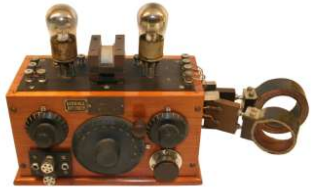
2 Röhren Batterieempfänger Schrack Type TR 1, 1924 Röhrengerät (Sammlung E. Macho)
