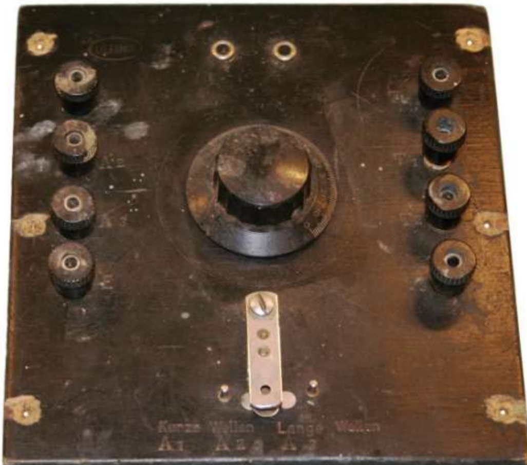
Bedienplatte des ULTIMA-Detektorapparates mit erkennbaren Abriebspuren des nicht mehr vorhandenen originalen Abstimmknopfes
