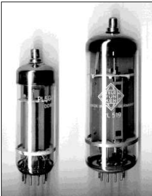
Oben: Eine jeweils neue unbenutzte Horizontalendröhren PL504 und die PL519 speziell für den Einsatz im Farbfernseher
