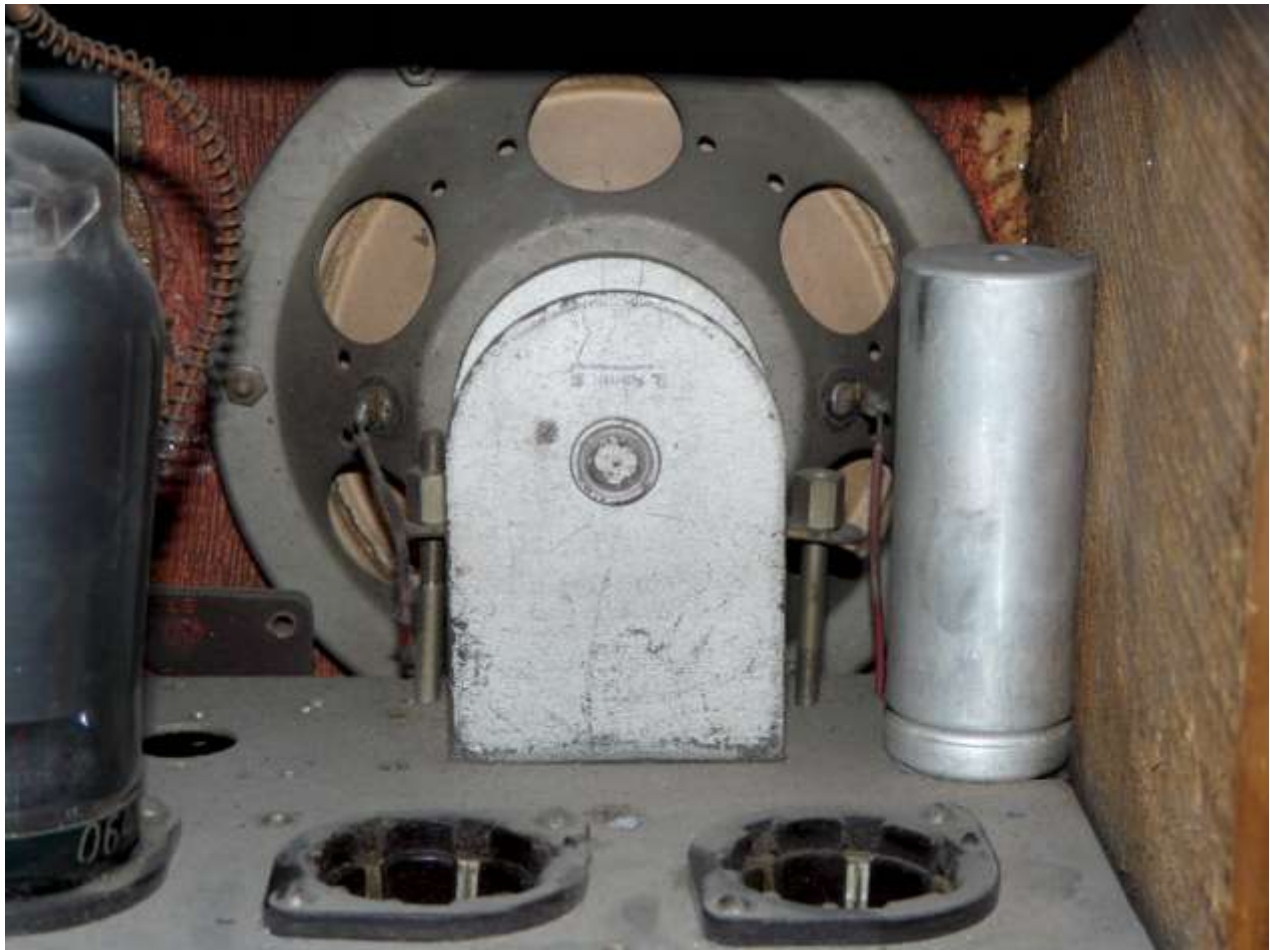
Blick auf den Lautsprecher bei gezogener Gleichrichter- und Stromregelröhre
