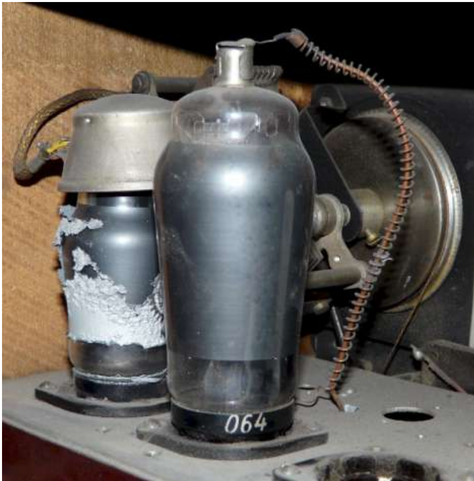
Sicht auf die Audionröhre (links) und Endröhre (rechts), dahinter Drehkondensator
