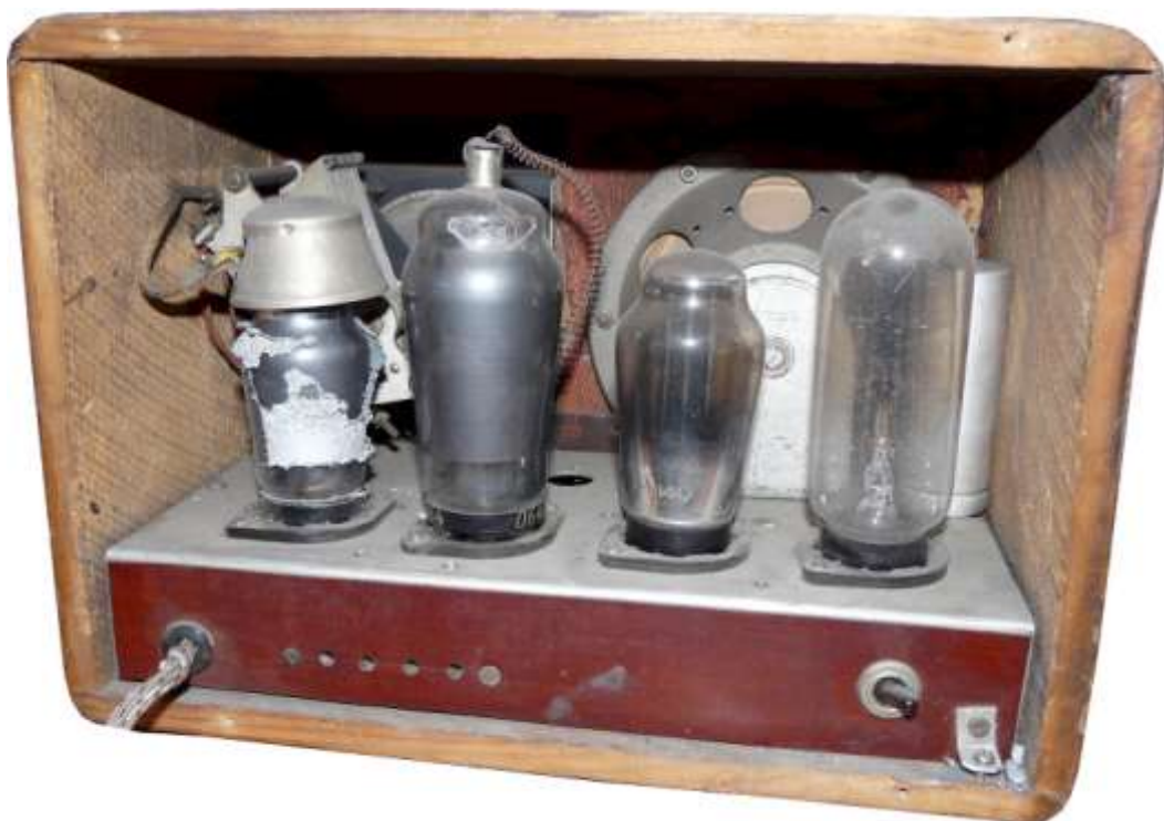
Gerät bei abgenommener Rückwand (von links nach rechts die Röhren NF2, CL4, CY1, Urdox: EU VI)
