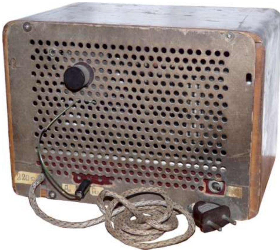
Ansicht von der Rückseite, zu sehen ist der Bedienknopf für den Sperrkreis und der Ein-Aus-Kippschalter
