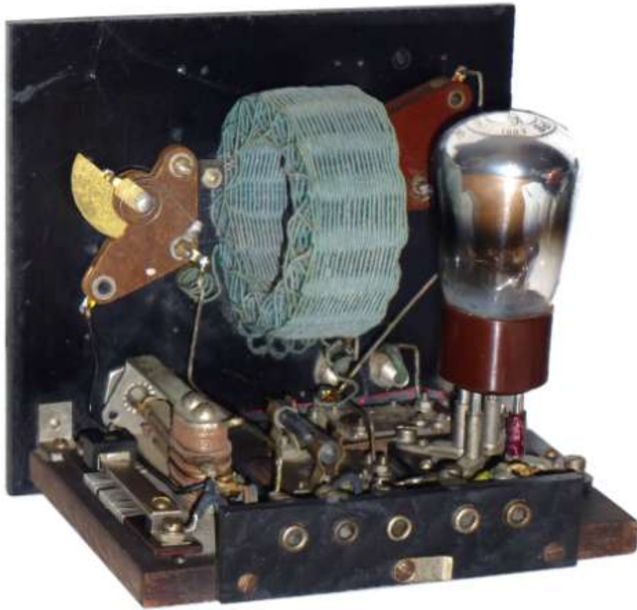
Blick in das Innenleben dieses Einröhrenapparates, die Bezeichnung der Buchsen sehen Sie auf der letzten Seite
